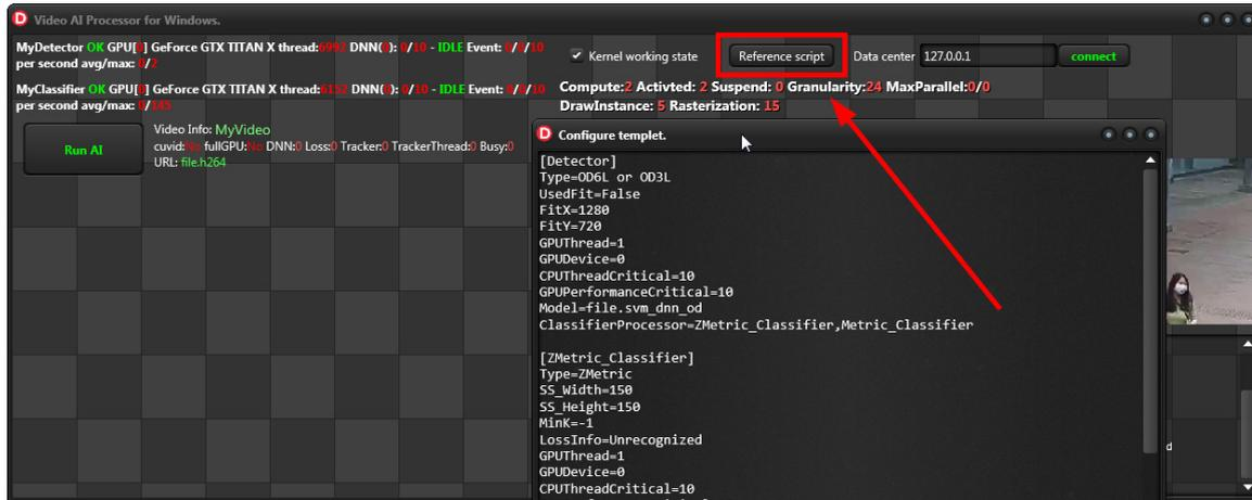
通过 Configure templet 窗口我们可以得到 4 种程序模块配置，分别是 Detector，ZMetric，Metric，video
