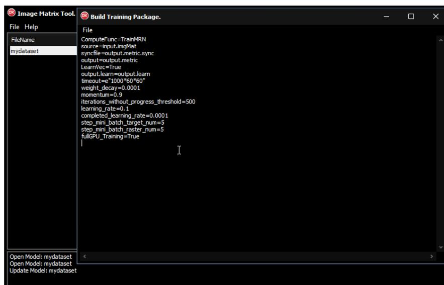
待超参数编辑完成后，使用 build Training Package，将数据集保存成 c:\input.ox
